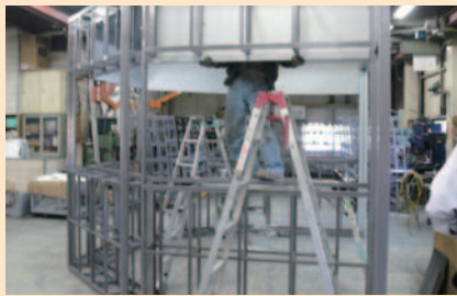
細見工業では、展示ケースのほか、展示会ディスプレイや店舗什器の製造も行っている。この写真は展示会ディスプレイを現場搬入する前に、不都合な点がないかどうかチェックするため工場内で仮組みしているところ
